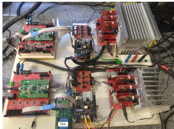
Figura 3: Bancada com inversores trífases para controle da MSIP e da máquina de indução.
